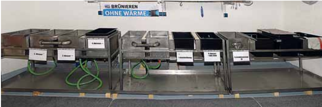
Abb. 8: GIMA-Versuchsanlage für Kaltbrünierungstests
