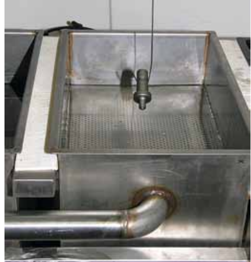
Abb. 4: Kaltbrünieren erfolgt in offenen Behältern und ohne dass neben Handschuhen und Augenschutz spezielle Sicherheitskleidung oder Absaugungen nötig wären
